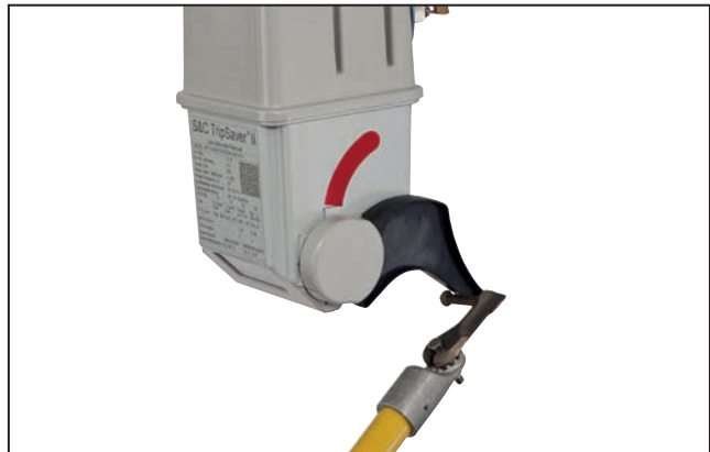
Figura 10. Coloque la pértiga bajo la palanca y empuje hacia arriba para ingresar al modo Auto.
