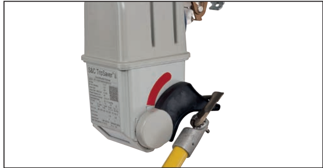
Figura 9. Colocar la pértiga sobre la palanca y jalar hacia abajo para ingresar al modo NR.
