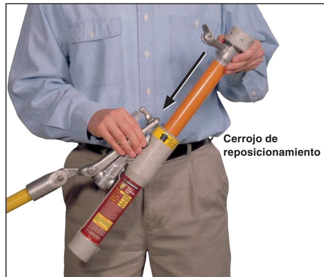
Figura 34. Reajustando una herramienta Loadbuster.
