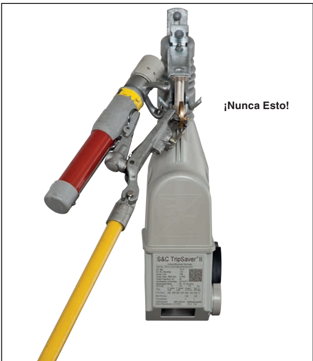
Figura 29. Un método incorrecto de sujeción.
